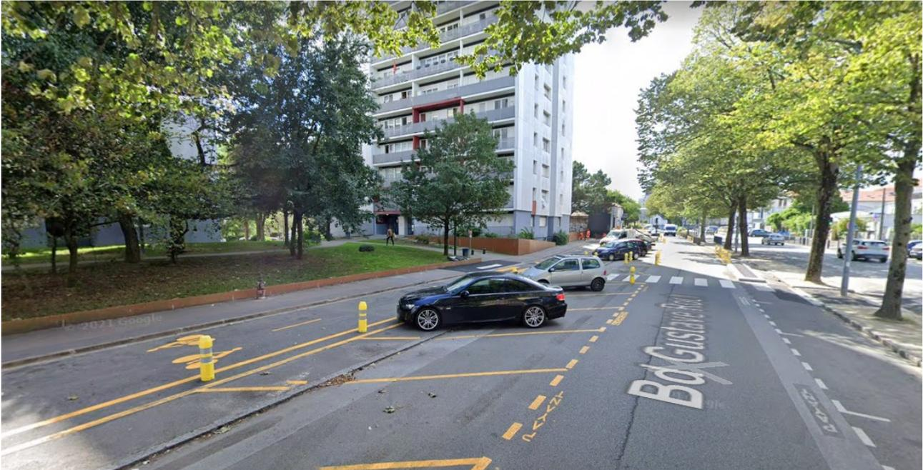
**Bd Gustave Roch, Nantes (déplacement des places de stationnement sur la chaussée pour dégager un espace permettant de réaliser une piste bidirectionnelle cyclable)**
