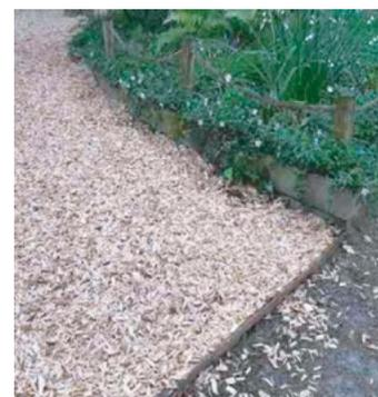
La limite de la zone de copeaux sera si possible affleurante. Un point d'entrée en pente doit être prévu pour permettre à un fauteuil de passer lorsque le copeau est plus tassé.
