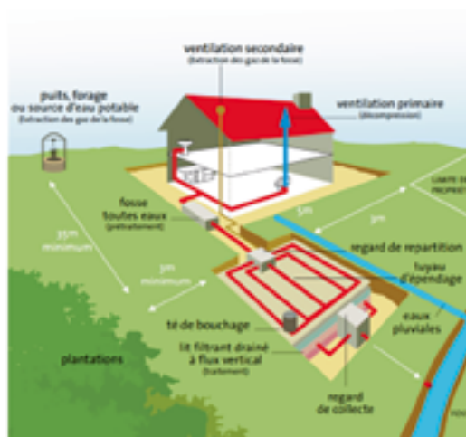
Principe de l'assainissement non collectif
