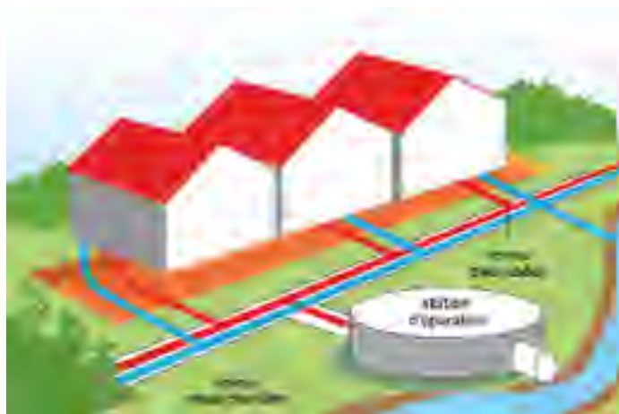
Principe de l'assainissement collectif
